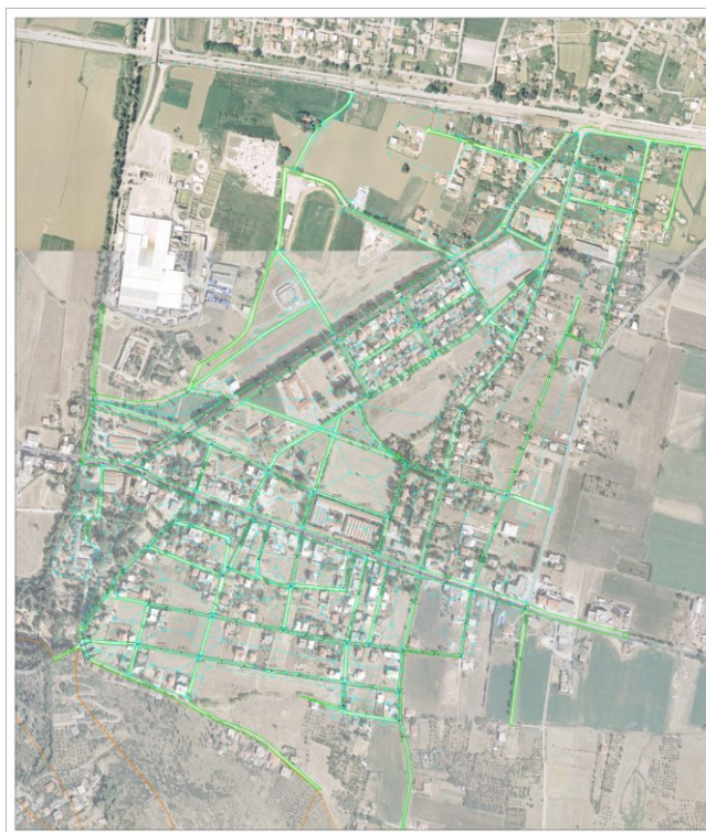
Εικ. 16 Υφιστάμενο δίκτυο αποστράγγισης ομβρίων για το τμήμα του οικισμού ανάντη του Σιδηροδρομικού δικτύου κατασκευασμένο από το πρόγραμμα "Αντώνης Τρίτης"
