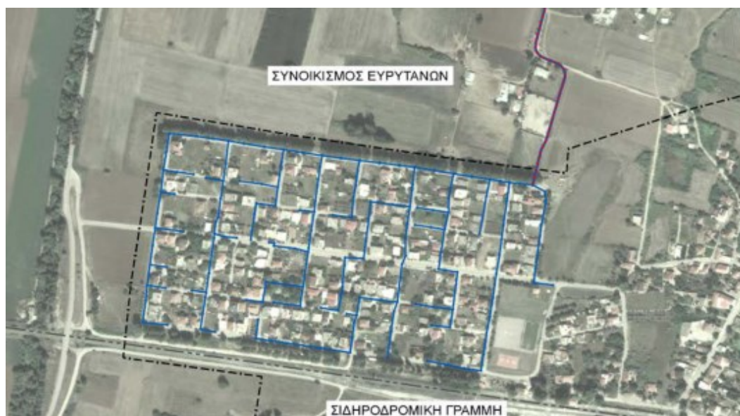
Εικ. 17 Υπό ένταξη δίκτυο αποστράγγισης ομβρίων για το τμήμα του οικισμού Ευρυτάνων.
